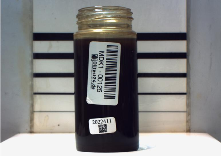
Die Probe ist trüb. Dies deutet auf eine Vermischung mit einer unlöslichen Komponente hin.
